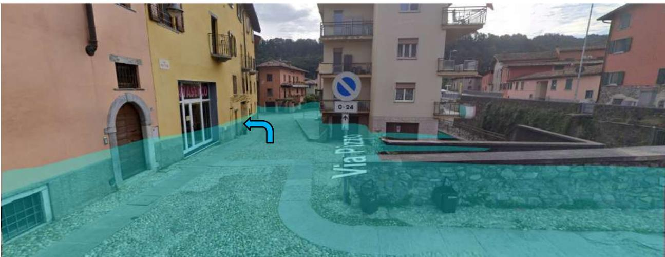
*zona di esondazione in via Pizzo dal ponte San Carlo (la freccia indica la direzione verso l'ingresso carrale del civico n.21; in trasparenza il livello d'acqua); l'acqua del torrente rimane in alveo in questo tratto.*
