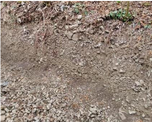
A) terreni attribuibili a conoide, ma anche a detrito di falda per l'assenza di qualsiasi struttura deposizionale collocati presso un tracciolo di servizio al taglio bosco; B) terreni di natura calcareo dolomitica in matrice limo-sabbiosa simili ai depositi alluvionali antichi/fluvio-glaciali presenti sulle sponde del torrente Vertova ed ubicati presso i gabbioni a sostegno della scarpata prima della curva che si innesta alla parte occidentale di via Palì
