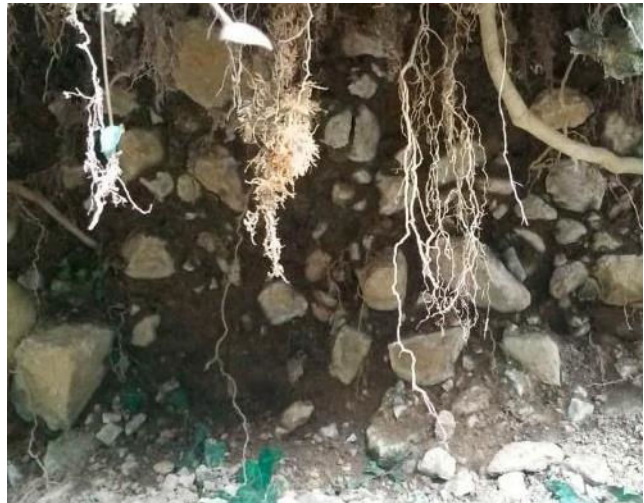
A) terreni attribuibili a conoide, ma anche a detrito di falda per l'assenza di qualsiasi struttura deposizionale collocati presso un tracciolo di servizio al taglio bosco; B) terreni di natura calcareo dolomitica in matrice limo-sabbiosa simili ai depositi alluvionali antichi/fluvio-glaciali presenti sulle sponde del torrente Vertova ed ubicati presso i gabbioni a sostegno della scarpata prima della curva che si innesta alla parte occidentale di via Palì
