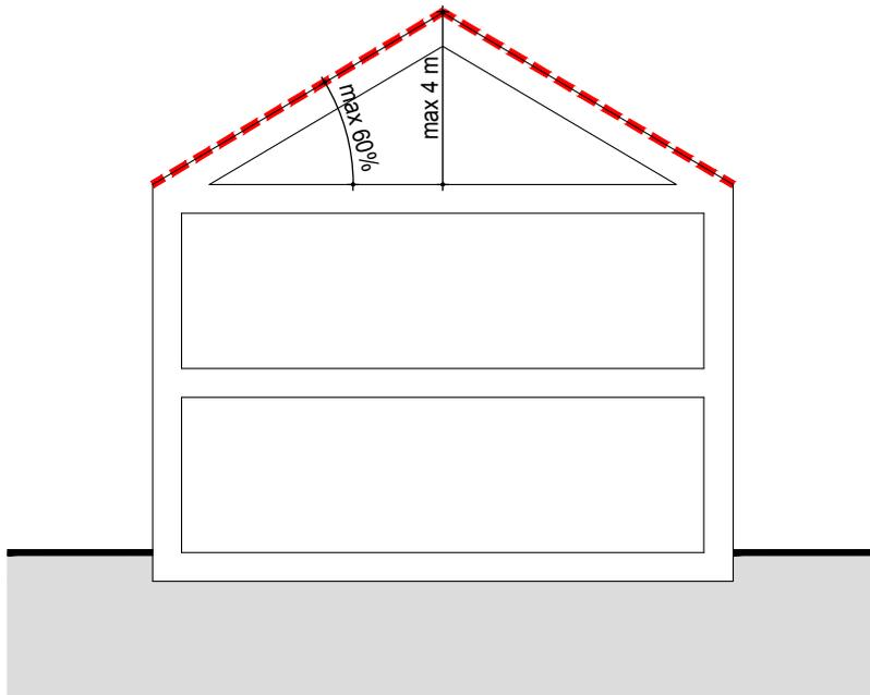
conformazione della copertura: copertura inclinata
