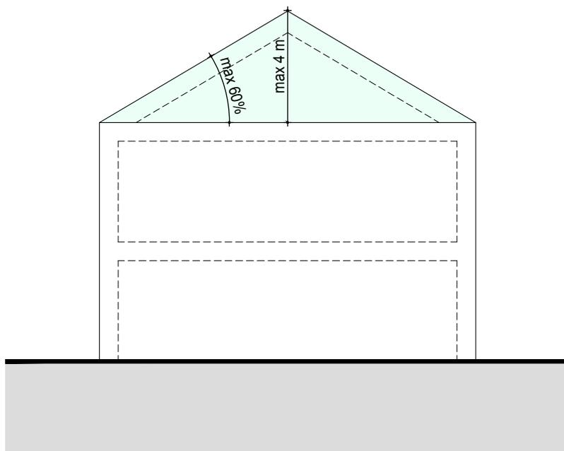
conformazione della copertura - calcolo dell'altezza del fronte
