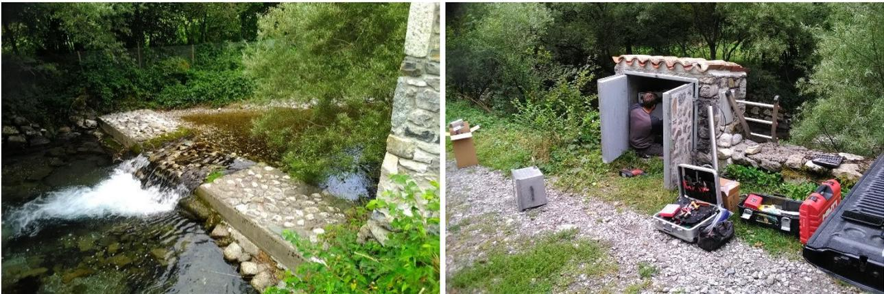
*Misuratore di portata del torrente Vertova con la soglia di misurazione e la cabina con la strumentazione di registrazione in continuo.*
